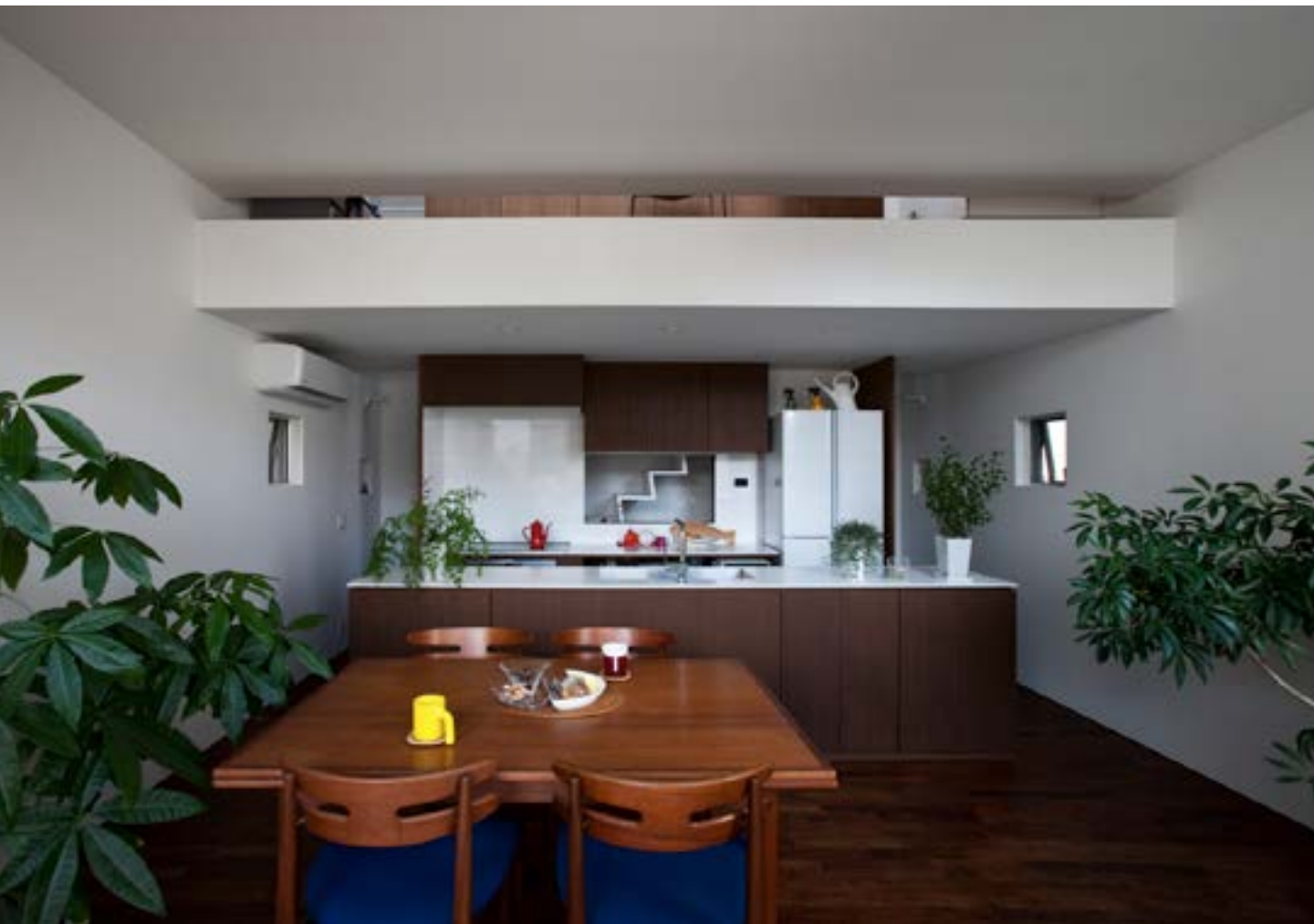
LDK北方向を見る。東西は隣家に挟まれているため、通風の小さな窓だけ。LDの天井高は2.8m、キッチンの天井高は2.2mで段差から3階がのぞく
